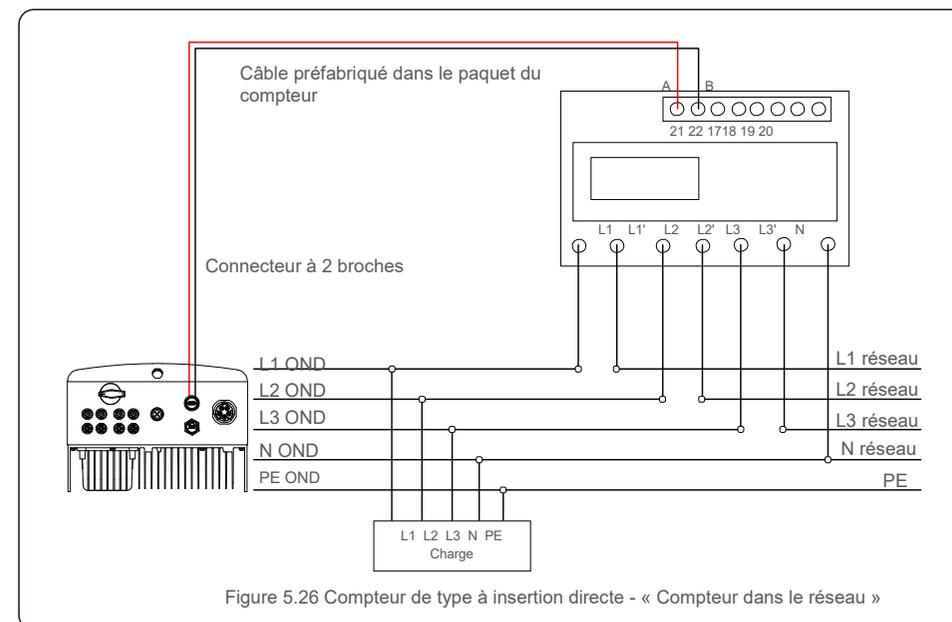
Figure 5.26 Compteur de type à insertion directe - « Compteur dans le réseau »
